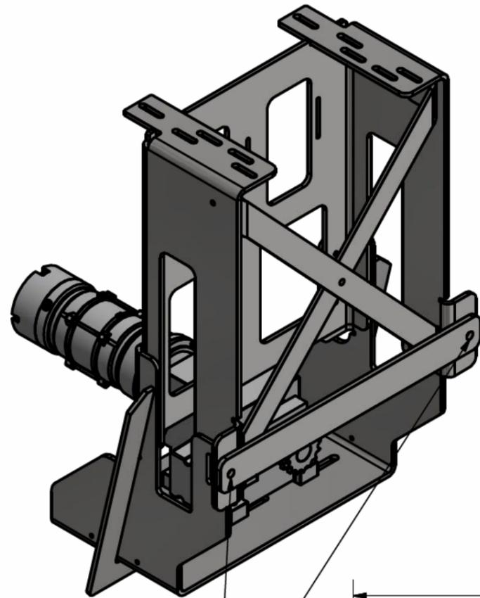
Optional Möglichkeit zur zusätzlichen Abstützung an seitlicher Gasbeton-Wand mittels 2 Stk. M16-8.8-Gewindestangen und den 2 lose mitgelieferten Konterflacheisen.
