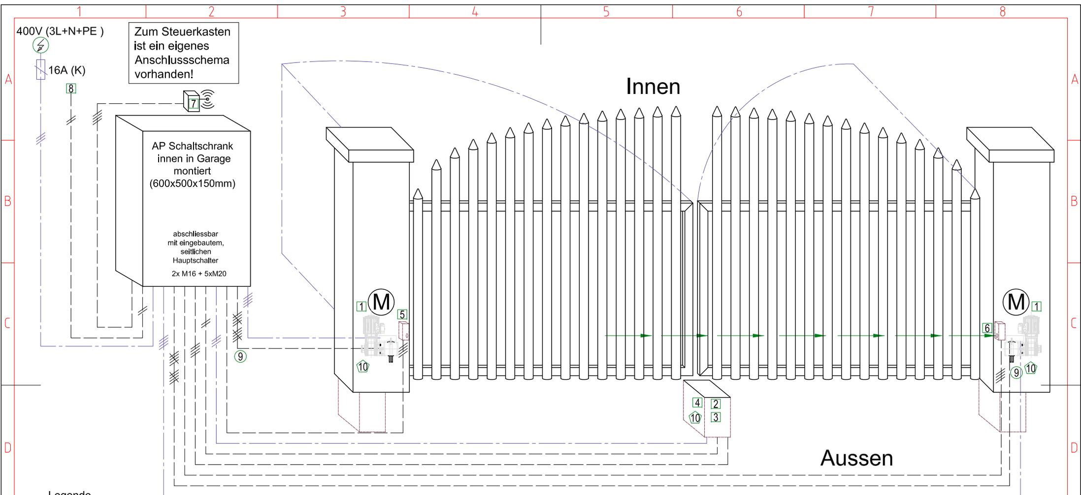
Zum Steuerkasten ist ein eigenes Anschlussschema vorhanden!
