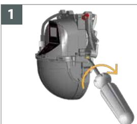
Sensorposition durch Festziehen der Winkeleinstellschraube fixieren.
