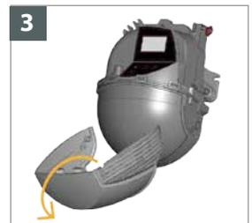
Die Abdeckung vor der Installation des Sensors vollständig abnehmen.
